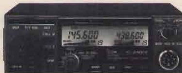
IC 2400 ICOM Transceiver doppio VHF/UHF
