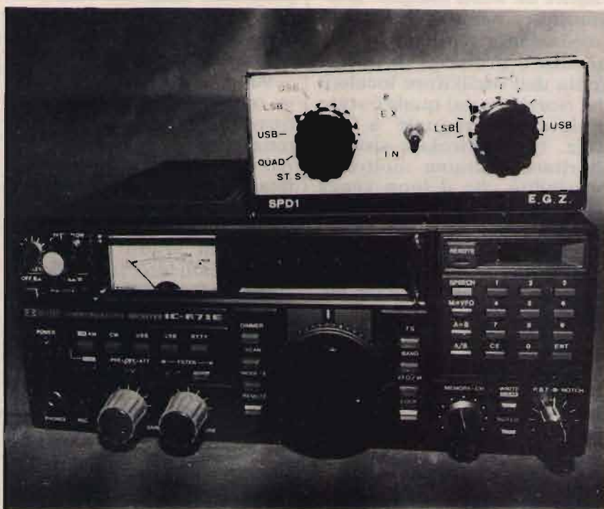
L'SPD1 in "tandem" con l'IC-R71E.
